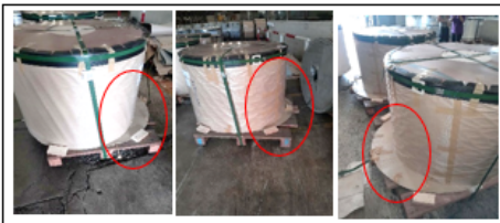
Fig. 2 : ความเสียหายที่ลูกคอยล์
